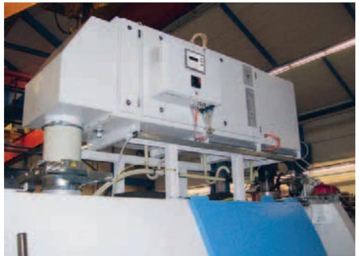
Bild 21 Dezentrale Absauganlage
