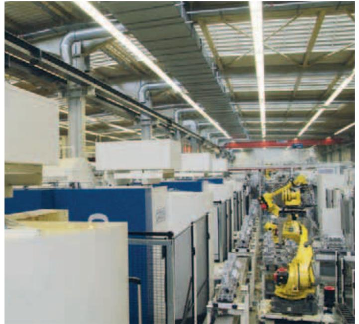
Bild 18 Dezentrale Absauganlage mit Einzelabscheidung
