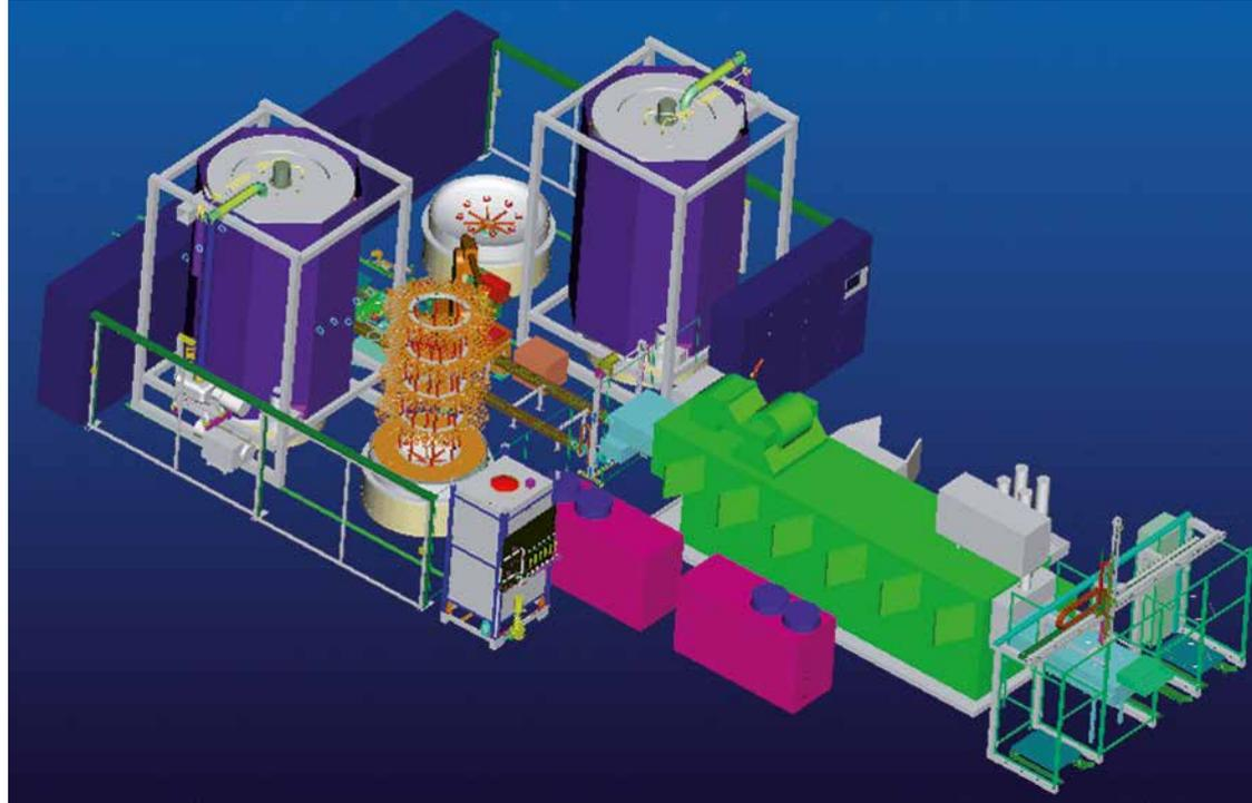
Vollautomatisiertes Anlagensystem bestehend aus Waschanlage, Chargierroboter, Laserbeschriftung, Handling von Teileträgern beim Be- und Entladen.
