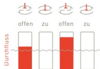
Abb4. Statisch abgeglichenes System bei Teillast
