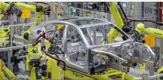
Roboterpositionsoptimierung von AI° im Karosseriebau Porsche Leipzig
