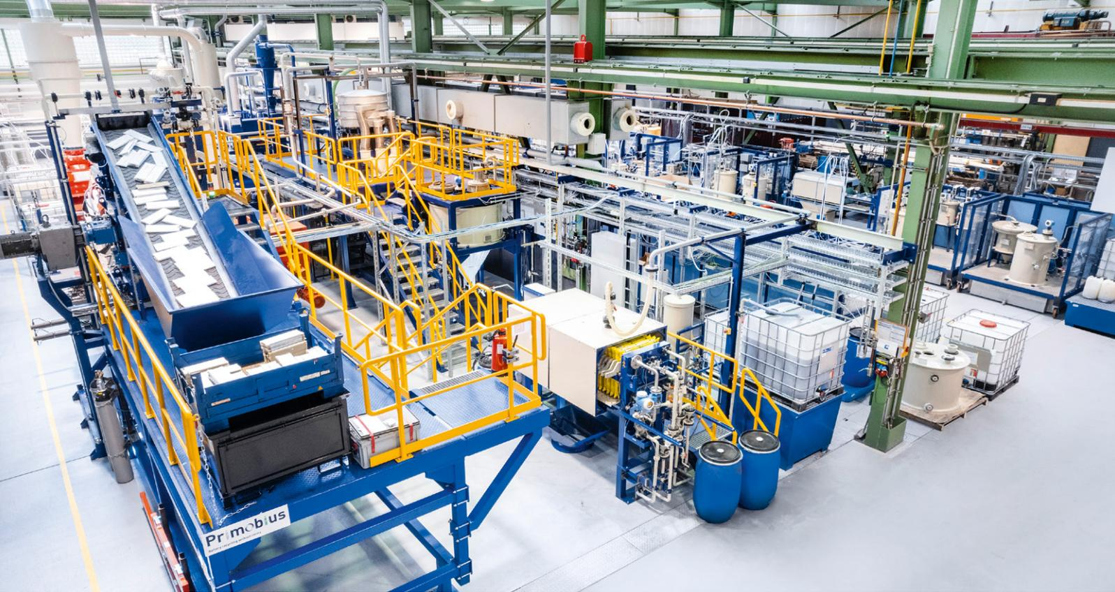
Beim Batterierecycling wird im ersten Schritt durch Schreddern von Altbatterien die „Black Mass“ gewonnen, die die Materialien für die Batterieherstellung enthält. Im hydrometallurgischen Teil werden dann etwa Lithium, Nickel und Kobalt extrahiert. Die hochreinen Materialien können anschließend wieder in der Kathoden- bzw. Batteriezellenproduktion eingesetzt werden.
