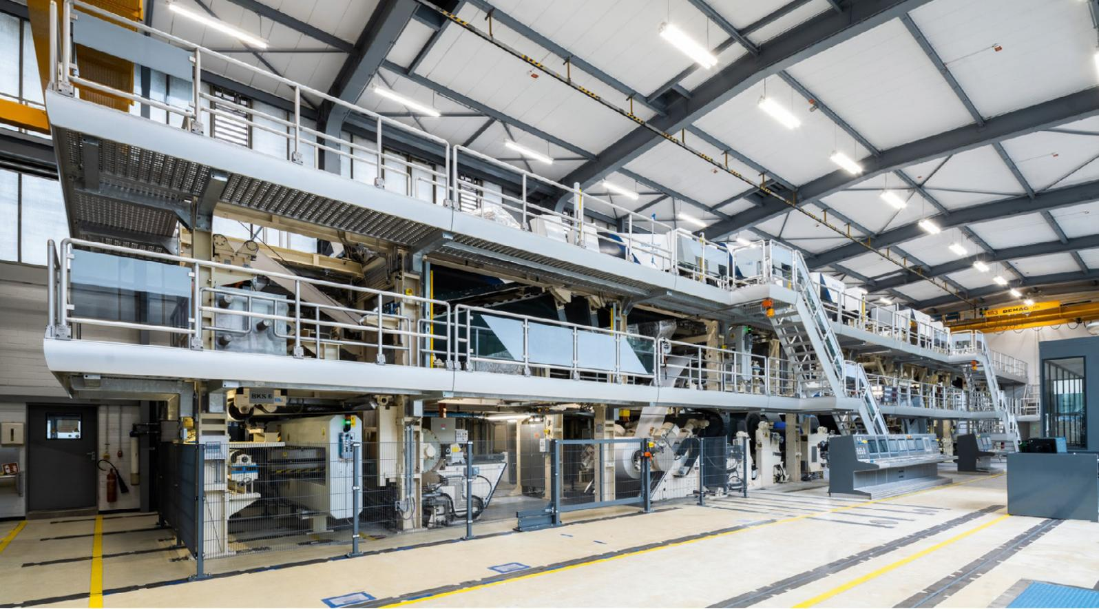
Mit der hier abgebildeten Versuchsstreichmaschine können kleine Chargen von Barrierepapieren für Markttests produziert und verschiedene Anlagenkonzepte getestet werden. Dadurch erhöht sich die Planungssicherheit für die Kunden bei zukünftigen Projekten.
