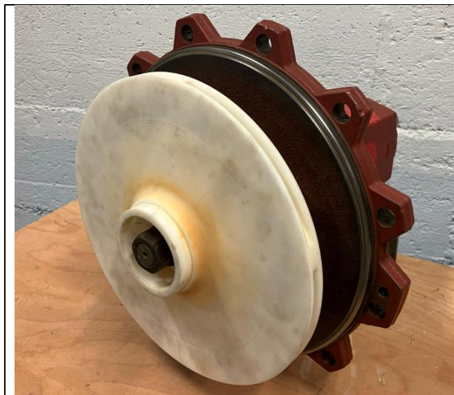
Eingebautes Laufrad nach mehreren Probeläufen (Bild: KSB)
