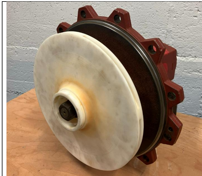
Eingebautes Laufrad nach mehreren Probelaufen (Bild: KSB)
