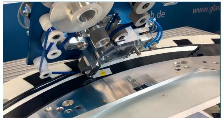
Abbildung 3.19: Ein TapeHead im Einsatz (Quelle: Glaub Automation & Engineering GmbH)
